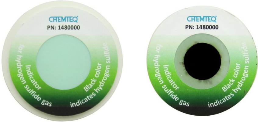
Şekil 10. Hidrojen sülfüre ( H_2S ) duyarlı tazelik indikatörü (Chemteq, 2024)
