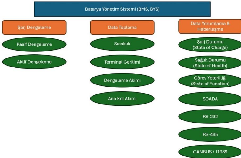
Şekil 1: Batarya Yönetim Sistemi (BMS) alt sistemler
