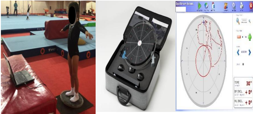
Resim 1. Tekno Body Denge Cihazı ve Başlıkları ve equilibrium testi ekran görüntüsü
