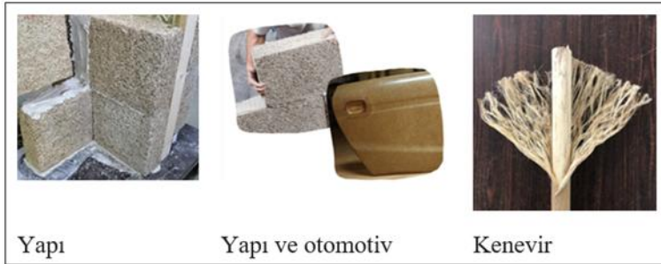
Şekil 12. Kenevir kompozitlerin yapı, otomotiv parçası örnekleri
