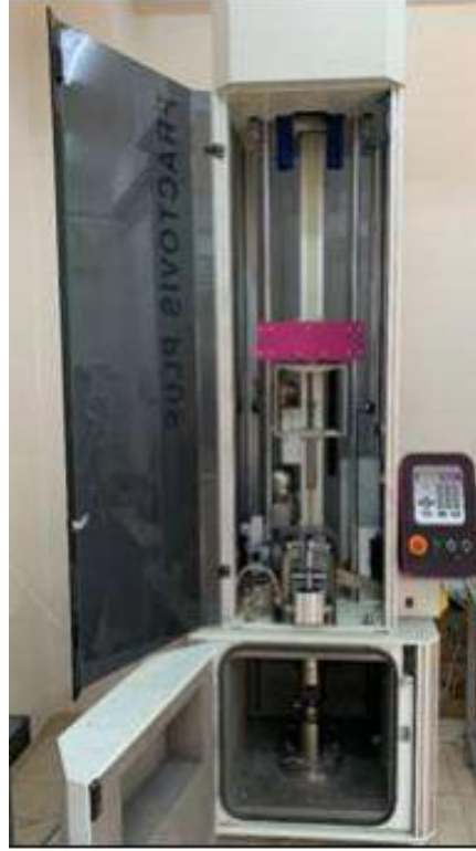
Şekil 7. CEAST Fracovis Plus darbe dayanımı test cihazı
