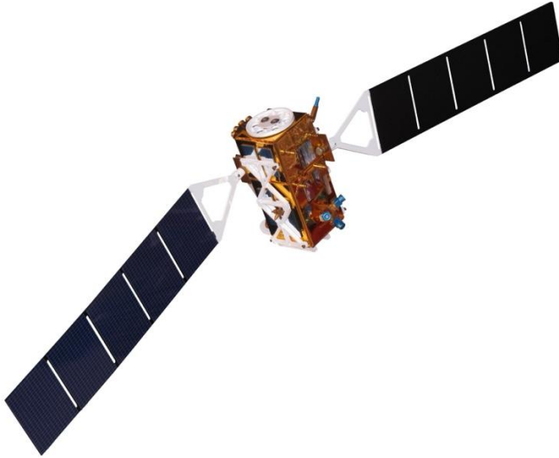
Şekil 8: Aktif Uzaktan Algılama Sistemlerinden olan SAR sistemi taşıyan Sentinel-1 uydu platformuna ait bir görünüm.
