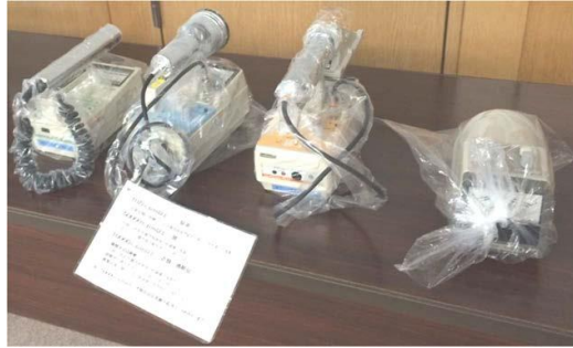
Şekil 2: Acil durum için hazırlanmış radyasyon ölçüm cihazları. Soldan sağa: sintilasyon probu; alfa parçacık yüzey kontaminasyon dedektörü; Geiger–Müller dedektörü, iyonizasyon odası.
