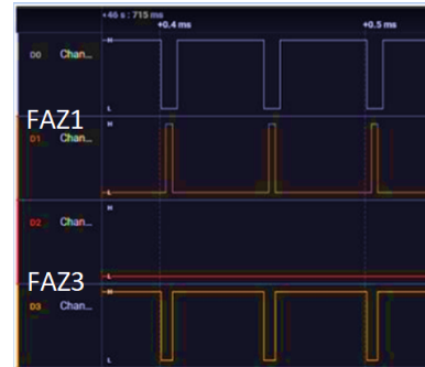
Şekil 3.b: Tamamlayıcı PWM ile sürme anahtarlama sinyali
