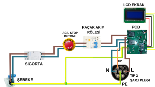
Şekil 5: Şebeke beslemeli şarj istasyonu elektrik hat şeması
