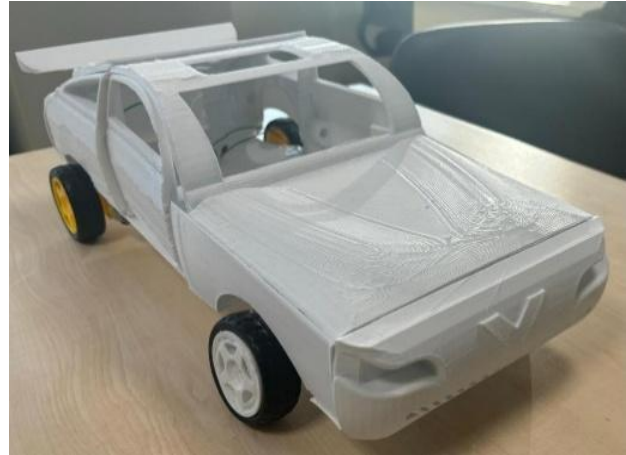
Şekil 1: 3D yazıcı teknolojisi kullanılarak elde edilen prototip otonom araç
