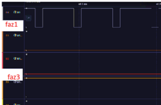
Şekil 2.b: PWM ile sürme anahtarlama sinyali
