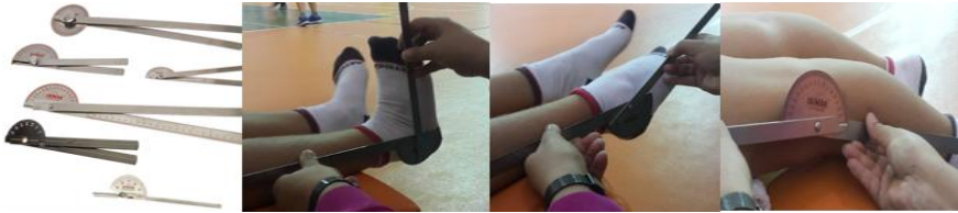
Resim 3. a:Gonyometre Seti ( https://www.performancehealth.ca ) b:dorsal fleksiyon, c:planter fleksiyon d:diz esnekliği ölçümleri
