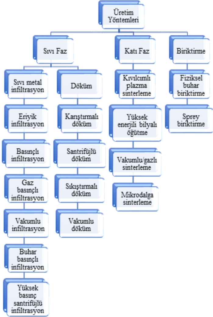
Şekil 7: Kompozit malzemelerin üretim teknikleri (Arunkumar, Sundaram & Vigneshwara 2020)
