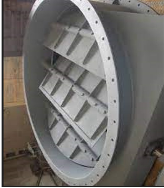
Şekil 4: Yüksek Sızdırmazlıklı Klepe
