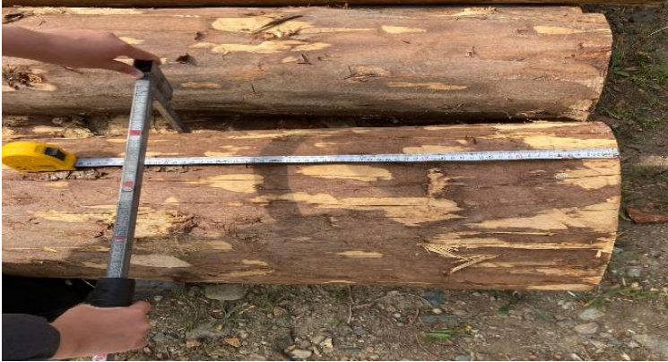
Şekil 4: Örnek tomrukların çap ölçer ile ölçümü
