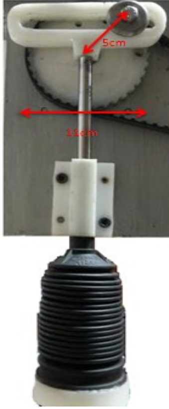
Şekil 2.17. Kompresyon için Scotch-Yoke mekanizması
