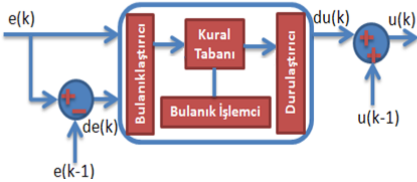
Şekil 1.18. Bulanık Mantık Denetleyici Genel Yapısı
