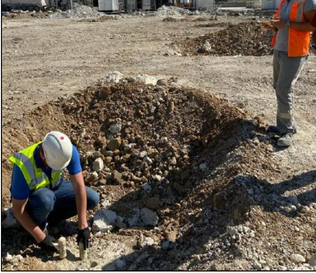
Şekil 7. Süreklilik Testi Uygulanışı
