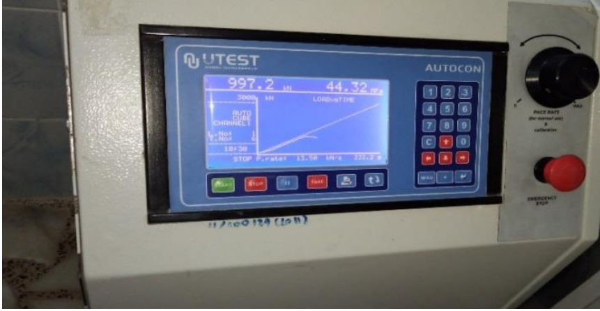
Şekil 2. Küp basınç deneyi cihazı ekran görünümü
