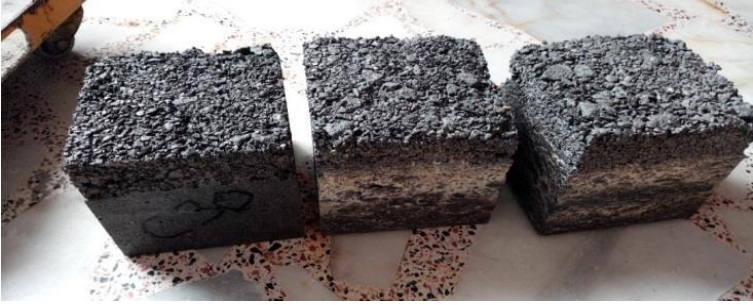
Şekil 12. B3 bazalt kumu kullanılarak üretilen numuneler
