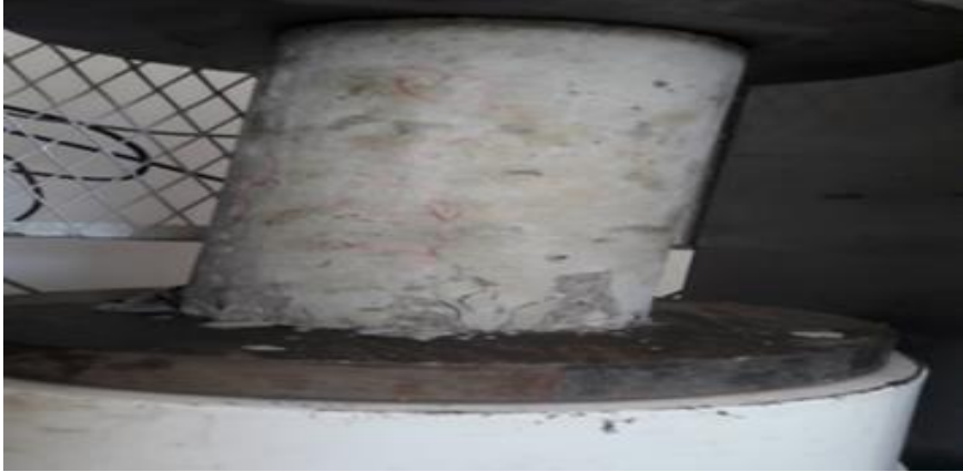
Şekil 4. Silindir numune kırılması
