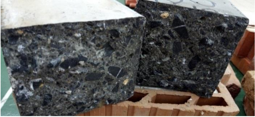
Şekil 8. Test sonrası kırılan prizmatik numune
