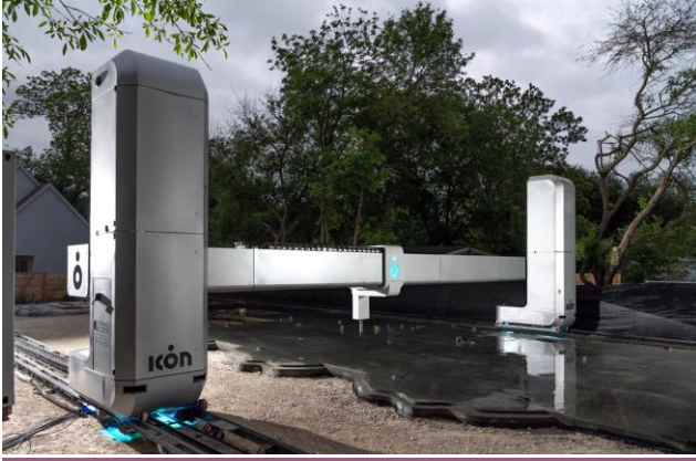
Şekil 5. Vulcan II 3D yazıcı (Web,2)
