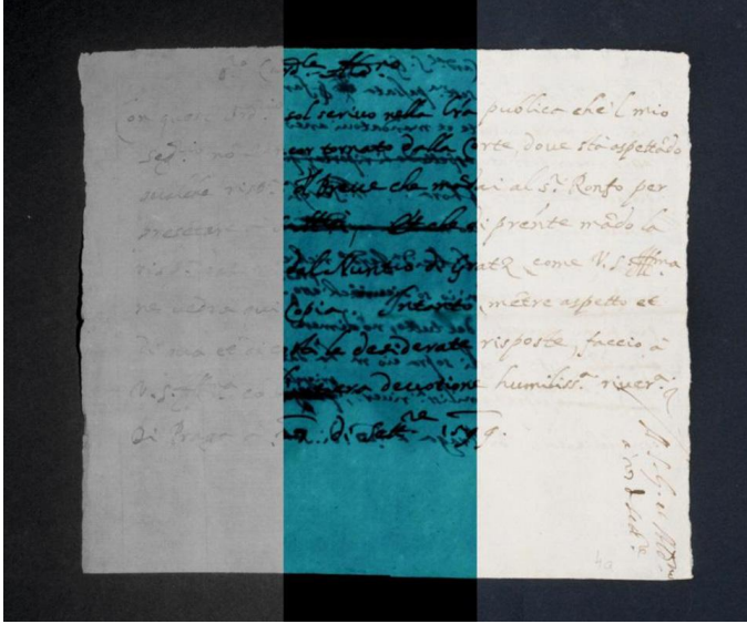
Resim 2. Sırasıyla NIR (950 nm), UV ve VIS ile fotoğraflanan tarihi el yazması.
